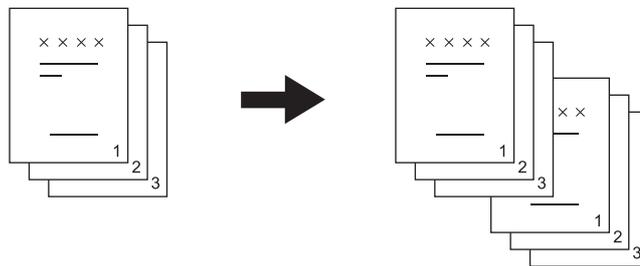
**TRI EN ALTERNANCE :** Lorsque vous effectuez plusieurs jeux de copies, les copies peuvent être triées et sortir alternativement dans le sens horizontal et vertical. Il s'agit d'un mécanisme d'alternance. Vous devez au préalable placer du papier dans une cassette en orientation paysage et du papier de même format dans une autre cassette en orientation portrait.
