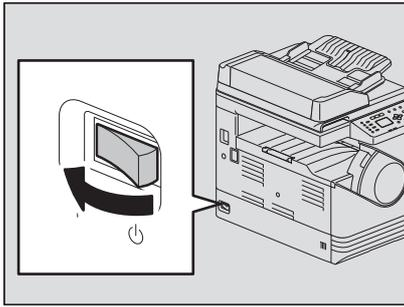
Démarre le préchauffage. À la fin du préchauffage, le système est prêt.
